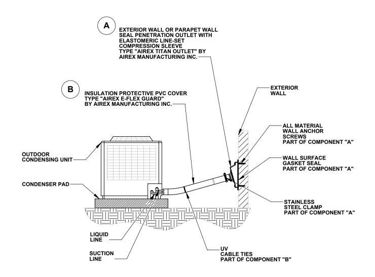
CONDENSING UNIT / REFRIGERANT PIPING DIAGRAM
